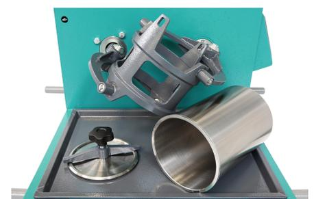
Несущей частью смесителя является корпус, разделенный на две части: в передней части расположен исполнительный механизм, в задней части - привод и система управления. Исполнительный механизм смесителя закрыт прозрачным колпаком. Чаша, в которую засыпается материал, вставляется в корзину, закрывается крышкой с прокладкой и фиксируется в корзине. Режим работы мотор-редуктора (частота вращения чаши) и необходимое время работы задаются с помощью системы управления.
