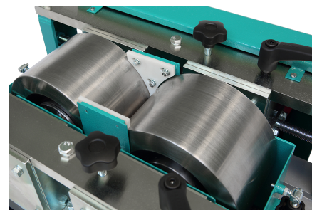
Валки и фторопластовые накладки
